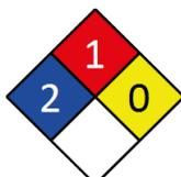
Remarque : Les numéros de catégorie de danger trouvés dans la classification SGH à la section 2 de ces FDS ne doivent PAS être utilisés pour remplir le losange NFPA 704. Bleu = Santé Rouge = Feu Jaune = Réactivité Blanc = Spécial (oxydant ou substance réactive à l'eau)
